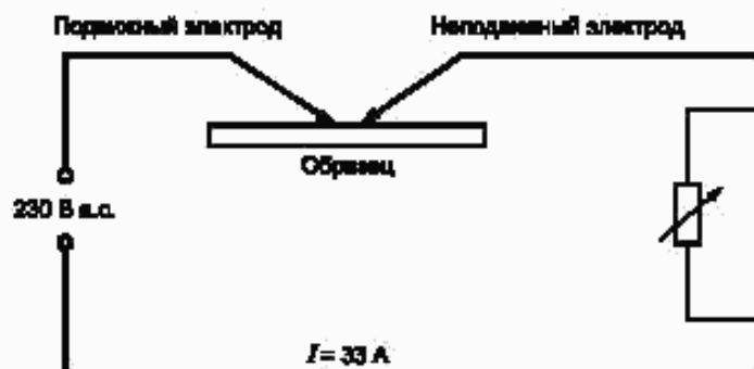
Рисунок М.2 — Схема для испытания на воспламеняемость электрической дугой
