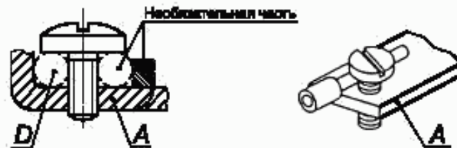
Выводы с прямым непосредственным давлением через головку винта
